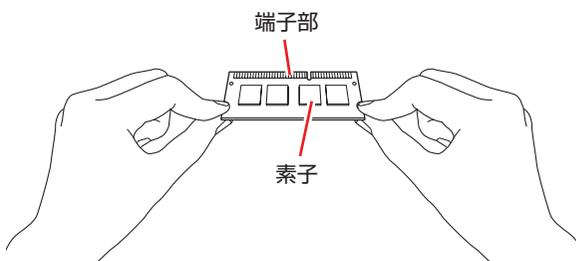
メモリー 1 枚で使用する場合は、下側の DIMM2 スロットに装着してください。2 枚装着する場合は、上下のロットとも、次の手順で取り付けます。
