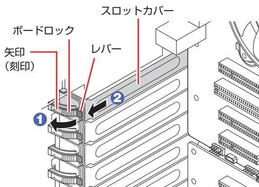
外したロットカバーは、大切に保管してください。拡張ボードを外したあと、別の拡張ボードを装着しない場合は、本体内部にホコリなどが入らないように、再びロットカバーを装着します。
