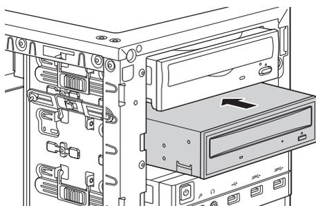
**7** 装置を 5.25 型ドライブベイに固定します。
