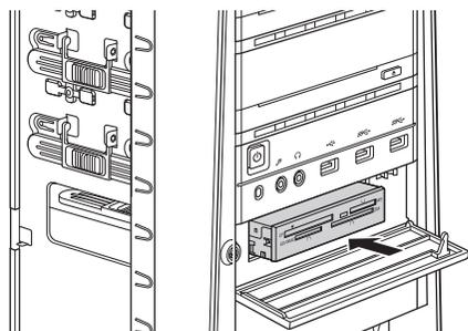
**7** 装置を 3.5 型ドライブベイに固定します。
