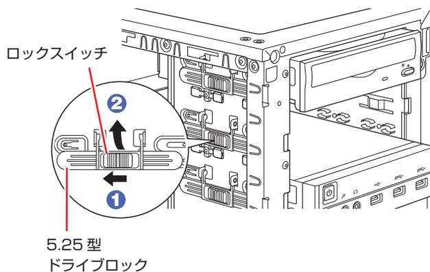
**6** 装置を 5.25 型ドライブベイに押し込みます。
