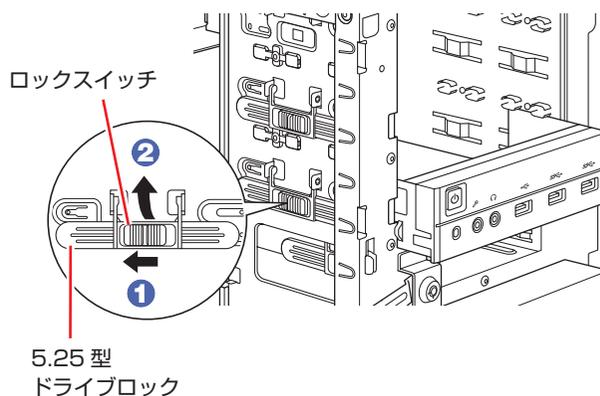
**8** ケーブルが接続されたままの状態、フロント I/O ユニートをベイから抜きます。フロント I/O ユニット右側のロックレバーを押しながら、引き抜いてください。
