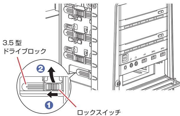
**6** 装置を 3.5 型ドライブベイに押し込みます。
