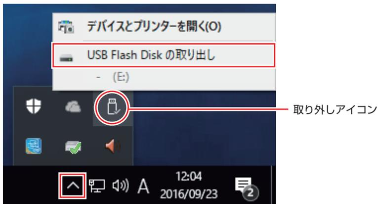
**3** 「ハードウェアの取り外し」メッセージが表示されたら、USB 機器を本機から取り外します。
