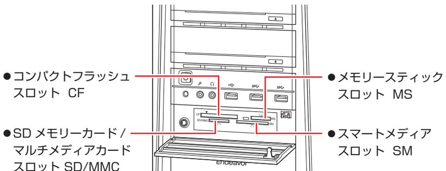
**2** メモリーカードのラベル面を上（端子面を下）に向け、対応するスロットにカードを差し込みます。
