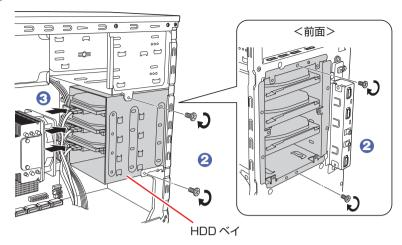
⑤ 周辺機器用電源ケーブルを HDD の電源コネクターに接続し、シリアル ATA ケーブルを HDD のコネクターとマザーボード上のシリアル ATA コネクターに接続します。
