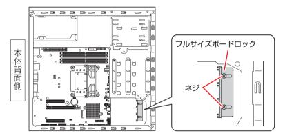
② フルサイズボードロックのスロットにボードを差し込み、<通常のボードの場合>と同様に、端子部をコネクターに差し込みます。
