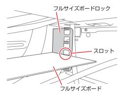
3 フルサイズボードロックのネジ(2本)を締めて固定します。
