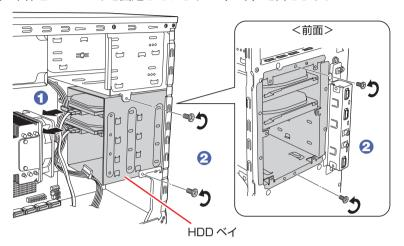
**3** HDD ベイを本体前面側から引き抜きます。 必ず両手で持って取り外してください。
