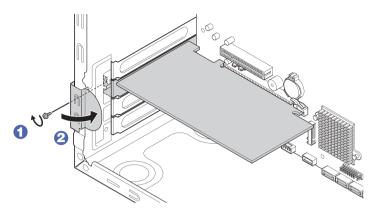
拡張ボードによっては、コンピューター内部のコネクターとのケーブル接続が必要な場合があります。拡張ボードのマニュアルで確認してください。
