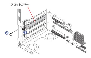
外したスロットカバーは、大切に保管してください。拡張ボードを外したあと、別の拡張ボードを装着しない場合は、本体内部にホコリなどが入らないように、再びスロットカバーを装着します。
