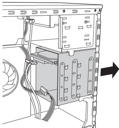
**7** HDD/SSD ベイに HDD を取り付けます。
