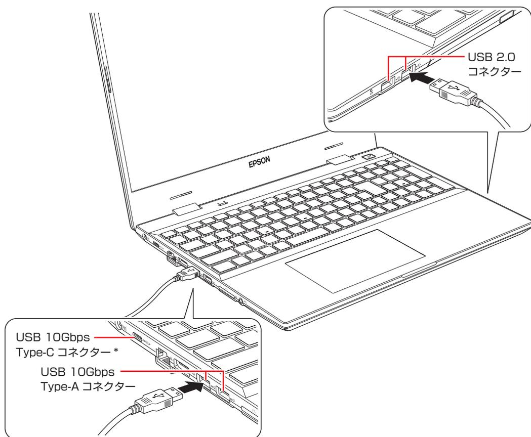
\* USB Power Delivery 対応。最大出力：15W (5V-3A)。
