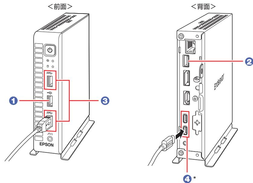
\* 背面下側の USB 10Gbps (USB 3.2 Gen2) (Type-C) コネクタは、USB Power Delivery (最大 15W 出力) に対応しています。ディスプレイに電源供給する場合は、背面下側の Type-C コネクタを使用してください。
