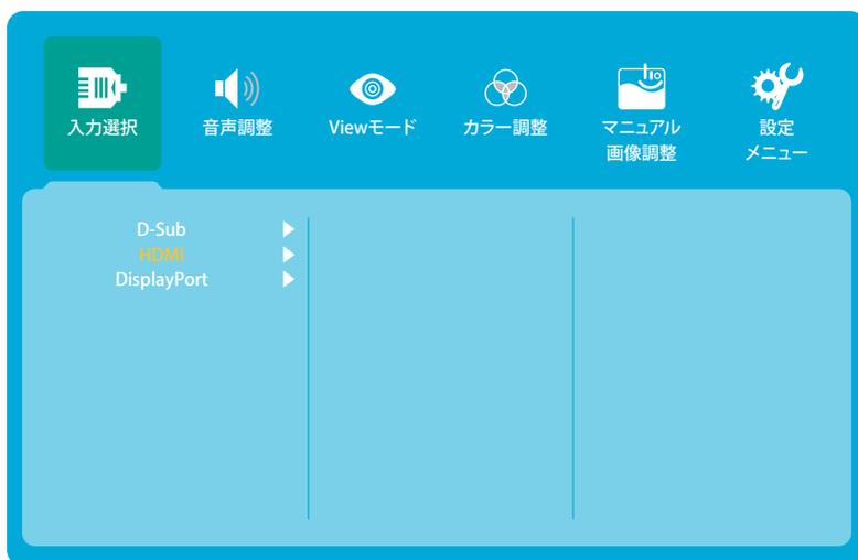
「入力選択」では、表示している画面の入力方式が選択されています。本機に接続した複数台のコンピューターの画面を切り替えるときは、入力方式を変更してください。
