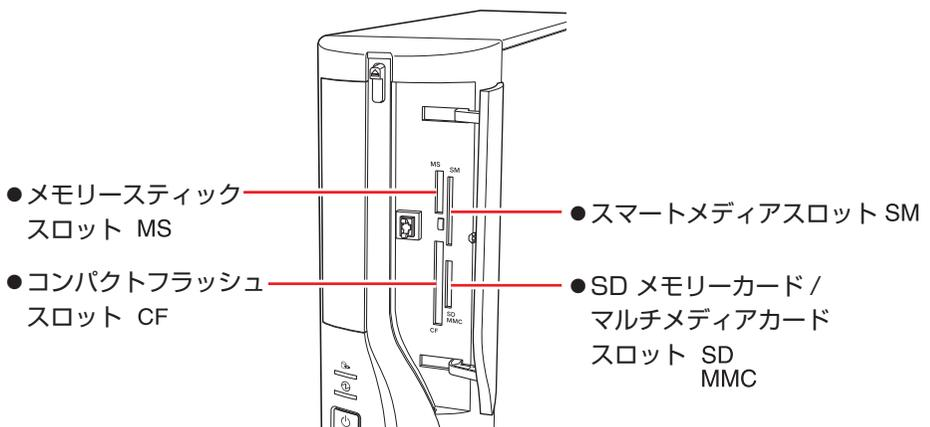
**2** メモリーカードのラベル面を左側（端子面を右側）に向け、対応するスロットにカードを差し込みます。
